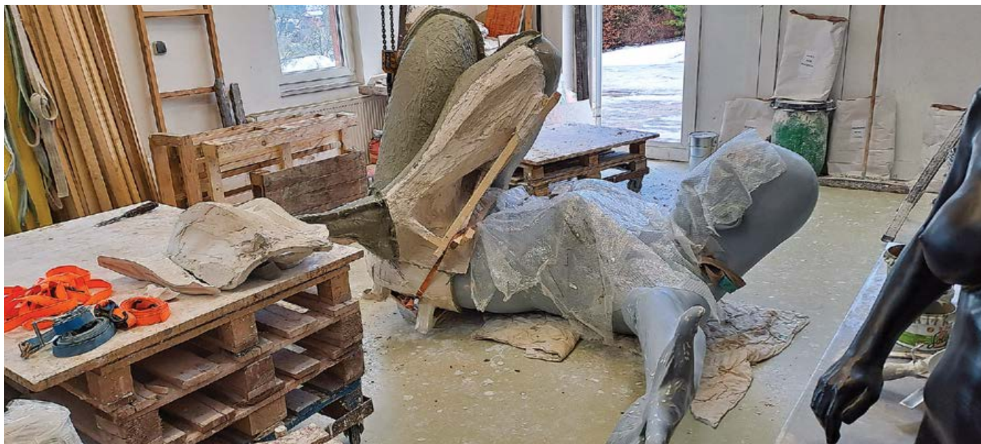
Obr. 17: Do jednotlivých dílů si ve slévárně odlili vosk o tloušťce 3 až 5 milimetrů.
