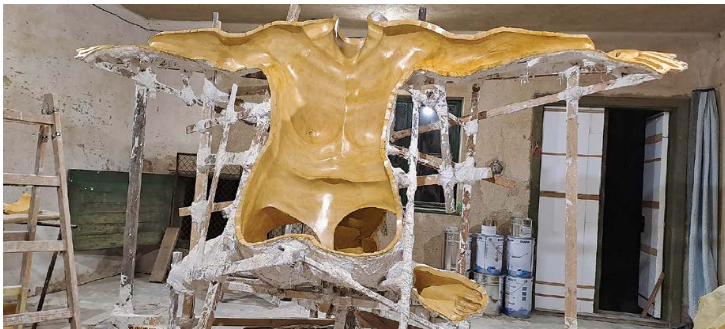
Obr. 10: Příprava formy na odlévání z plastu, resp. laminování.
