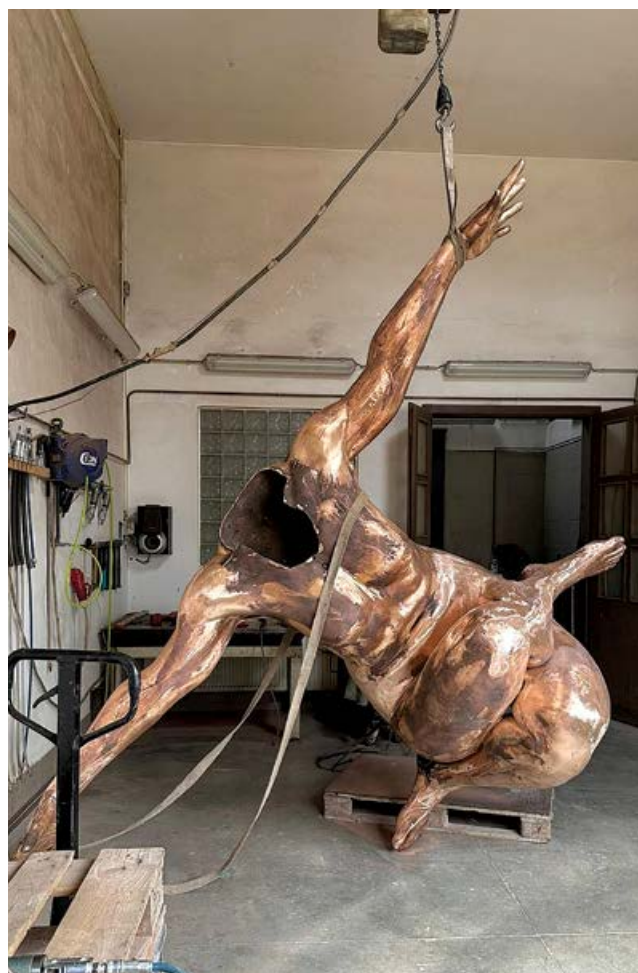
Obr. 19: Jednotlivé díly bronzu se svaří do jednoho celku - celé sochy a jemně se obrousí.
